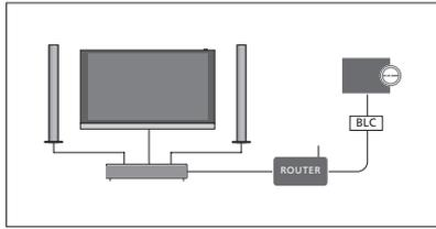
Le téléviseur et un système audio sont installés dans une même pièce et toutes les enceintes sont connectées au téléviseur :
