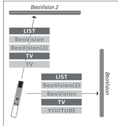
*Exemple de fonctionnement de la télécommande lorsque vous passez d'un téléviseur avec Network Link à l'autre.*
