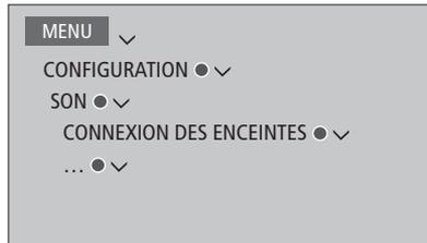
*Important ! Si vous sélectionnez le type d'enceinte LINE dans la liste CONNEXIONS ENCEINTES, le volume sera très élevé et vous ne pourrez pas le régler à l'aide de votre télécommande BeoRemote One. Vous devez utiliser la télécommande de l'appareil. LINE s'emploie par exemple pour les amplificateurs non fabriqués par Bang & Olufsen.*
