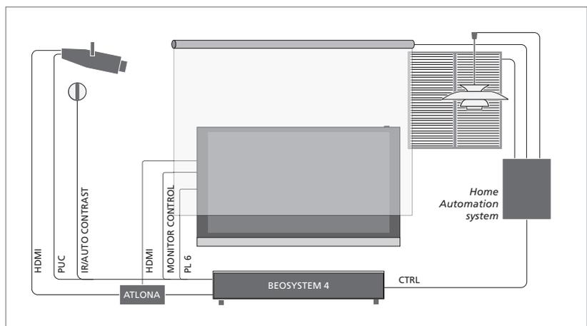
Exemple d'installation à deux écrans. Nécessite un commutateur Atlona.
