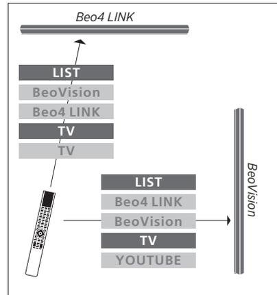
*Exemple de fonctionnement de la télécommande lorsque vous basculez entre un téléviseur avec Network Link et un téléviseur avec Master Link.*
