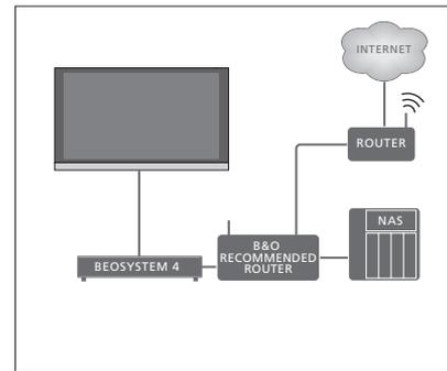
Exemple d'installation réseau recommandée.
