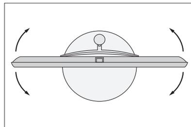
Le processus d'étalonnage vous permet de définir l'angle de rotation maximal du téléviseur – vers la gauche et vers la droite.
