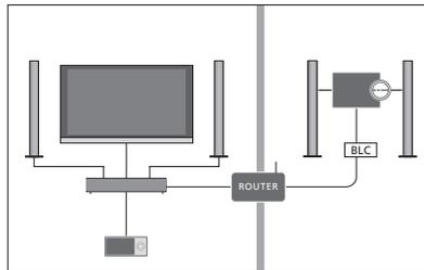
Il faut pour ce faire installer le téléviseur (et les enceintes qui l'accompagnent) et un système audio dans une même pièce puis installer un autre système audio dans une autre pièce :
