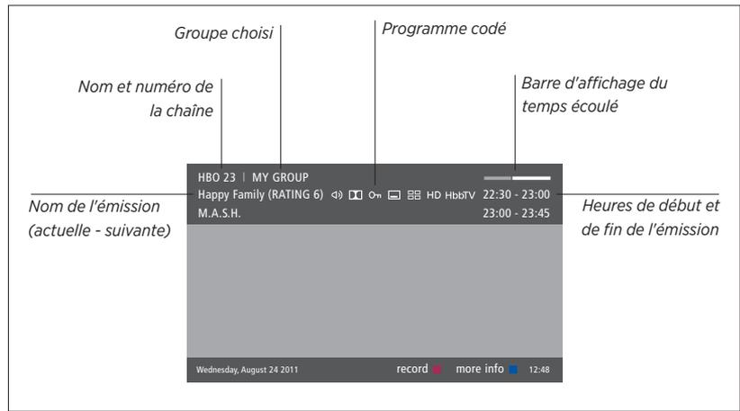
Pour afficher des informations supplémentaires sur une émission, appuyez sur **INFO** lorsque l'écran du téléviseur est allumé. Utilisez **<**, **>**, **^** et **v** pour avancer et reculer et pour parcourir les chaînes et le bouton **central** pour sélectionner une chaîne. Appuyez sur **BACK** pour fermer l'affichage des informations sur les émissions.
