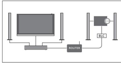
Le téléviseur, pourvu ou non d'enceintes supplémentaires, et le système audio comportant des enceintes connectées sont installés dans une même pièce :
